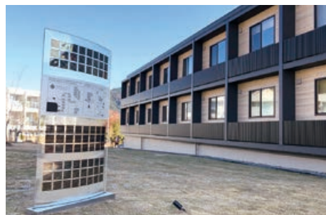
フィルム型次世代太陽電池を利用した看板 The power signage using the latest photovoltaic film cells
